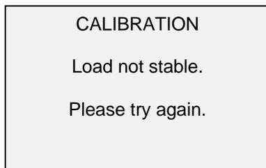
Stellen Sie sicher, dass die Last nicht in irgendeiner Art und Weise schwingt, pendelt oder vibriert. Versuchen Sie es anschließend erneut.
