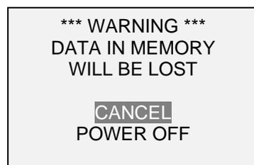
Wenn keine Option ausgewählt wird, wird dieser Bildschirm dauerhaft oder so lange angezeigt, bis die Akkukapazität zu Ende geht.
