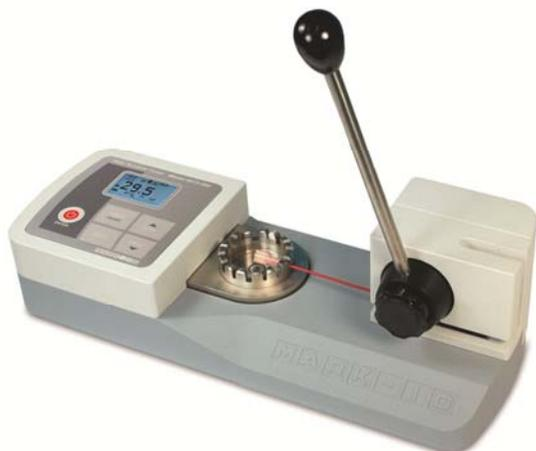
Vielen Dank, dass Sie sich für das Abzugskraft-Messgerät Mark-10-200 WT3 entschieden haben, das für Abzugskraft-Tests bis zu 200 lbf (1.000 N) ausgelegt ist.
